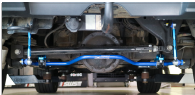
► Illustration of installed state 安裝完成示意圖
