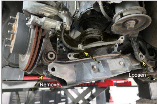
3. Install the lowering bracket to lower control arms using supplied M10, M6 bolts and spacers. 使用M10、M6螺絲及墊片，將降低座安裝至下支臂。
