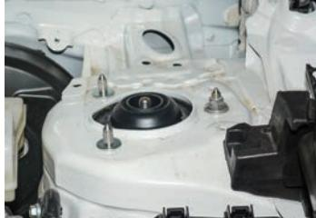
1. 須將"雨刷桿、雨刷蓋板、雨刷馬達、金屬蓋板"拆除
