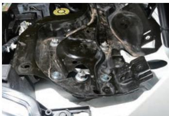
3. 安裝避震器塔座支架注意，先將避震器外側鎖點鎖上，並上扭力60Nm
